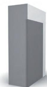
Bei stark saugenden Untergründen verhindert die Grundierung den zu schnellen Wasserzug aus der nachfolgenden Putzschicht.
