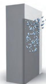
Die wasserabweisende Ausrüstung des Untergrundes senkt seine kapillare Saugfähigkeit bzw. hebt sie auf.
