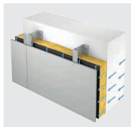
Ableitung von Kondensat und Tauwasser
